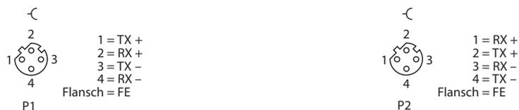
Abb. 13: Pinbelegung Ethernet-Anschlüsse
