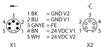
Abb. 17: Pinbelegung Versorgungsspannungsanschlüsse
