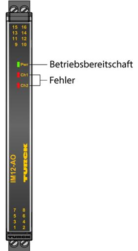
Über den 2-kanaligen Signaltrenner IM12-AO01-2I-2I-H0/24VDC wird das normierte Stromsignal 1:1 galvanisch getrennt übertragen. Neben dem Analogsignal können bidirektional auch digitale Signale der HART®-Kommunikation übertragen werden. Typische Anwendungen sind die Ansteuerung von I/P-Wandlern oder Anzeigegeräten.
