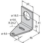
Soporte de montaje, en ángulo recto, acero inoxidable, para sensores con rosca de 18mm
