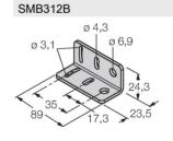
ángulo de montaje, acero inoxidable, para el modelo MINI-BEAM NAMUR
