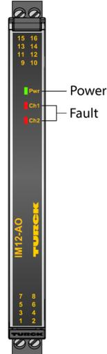
A través del separador de señal de 2 canales IM12-AO01-2I-2I-H0/24VDC se transmite la señal de corriente normalizada aislada galvánicamente en una relación 1:1 desde la zona no Ex a la zona Ex. Además de la señal analógica se puede efectuar también la transmisión bidireccional de las señales digitales de la comunicación HART®. Aplicaciones típicas son la activación de convertidores I/P o en equipos de indicación.
