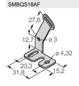
équerre de montage, acier inoxydable, pour filetage 18 mm
